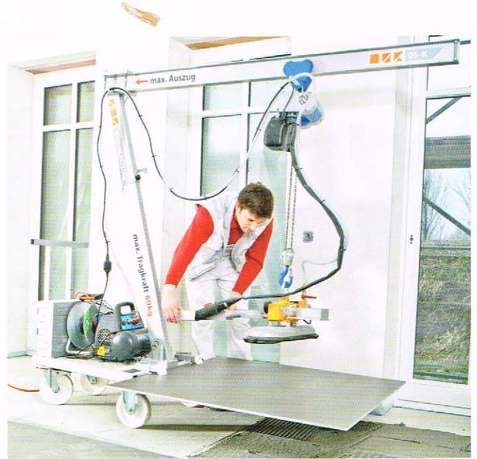
wickelt wurde, wird durch viele durchdachte Details sichtbar. So passt der Kran mit seiner Breite durch jede klassische Zimmertür (Breite: 90 cm). Er benötigt nur Lichtstrom, den es an jeder normalen Steckdose gibt. Darüber hinaus kann er komplett von einem einzigen Mitarbeiter transportiert, aufgebaut und genutzt werden. Der sonst nötige Unterstützer kann so schon auf einer anderen Baustelle aktiv werden.
